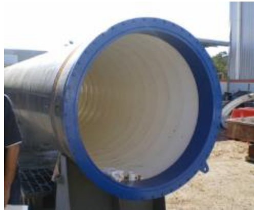
Horpadási próba PVC spiráltekerceseléses csöveken DN 1168 mm
