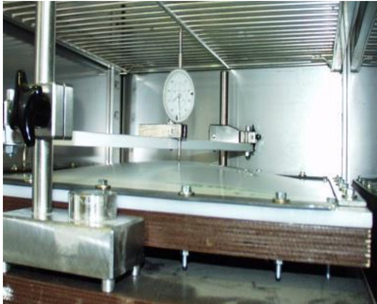
5.4b) ábra Rögzített PE lap melegítése hőkamrában
