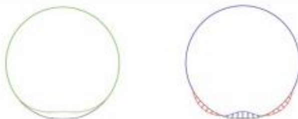
5.3c) ábra DN 3500-as átvezetés, alakváltozások és hajlító nyomatékok (LinerB 8.7 [9] által generált ábrák)
