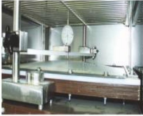
5.4b) ábra PE burkoló lap melegítése klímakamrában
