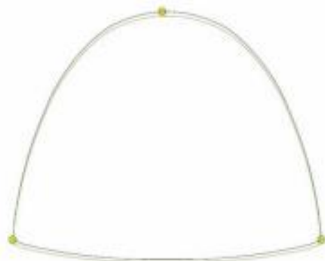
5.8b) ábra Az ív modellezése hárompontos csuklós boltozattal, folyásfenék: ép
