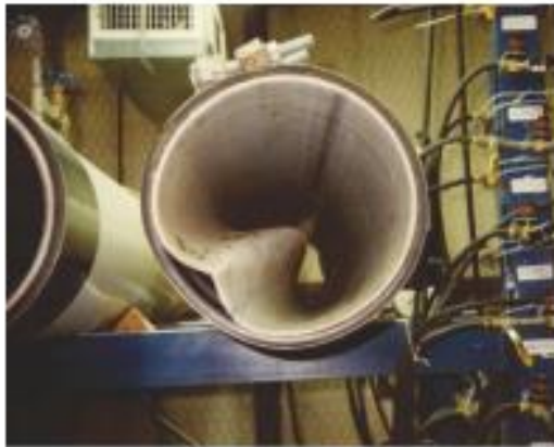
2.14 ábra: balra: CIPP-en végzett hosszú idejű behajlási/ horpadási próba, USA [4], jobbra: 33 CIPP-en végzett horpadási próba értékelése
